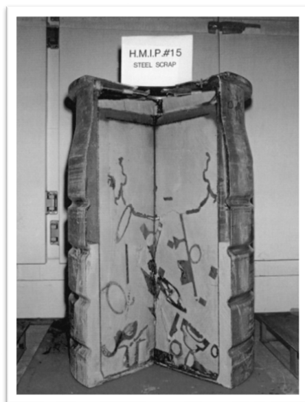
Slika 6.13. Čvrst, metalni radioaktivni otpad ugrađen u cementni matriks (IAEA TRS 390, http://www.pub.iaea.org/MTCD/publications/PDF/TRS390_scr.pdf )
