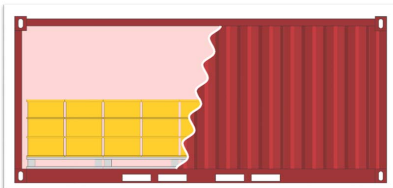
Slika 8.2. Način transporta nisko i srednje aktivnog radioaktivnog otpada u standardnom ISO kontejneru
