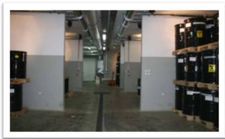
Slika 7.2 Primeri različitih načina slaganja kontejnera sa radioaktivnim otpadom u skladištu
