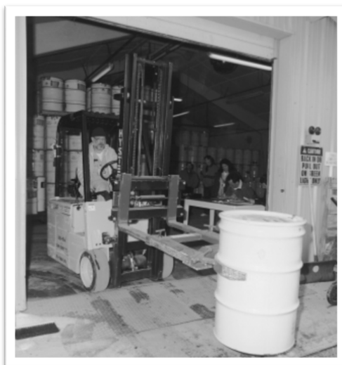
Slika 7.5. Manipulacija budarima od 200 l u skladištu radioaktivnog otpada (IAEA TRS 390, http://www-pub.iaea.org/MTCD/publications/PDF/TRS390_scr.pdf )
