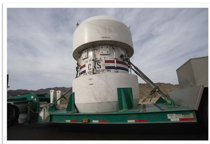
Slika 8.3. Način transporta isluženog nuklearnog goriva ( http://www.alphabetics.info/international/wp-content/uploads/2012/05/Nuclear_waste_container_2010_nevada.jpg )
