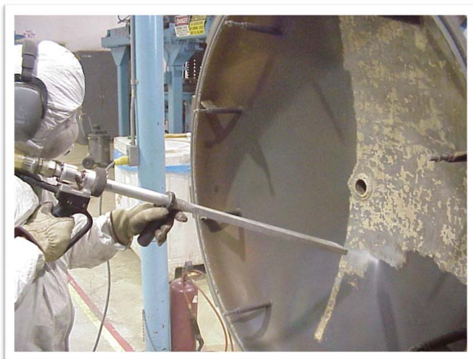
Slika 4.6. Dekontaminacija vodom pod pritiskom
