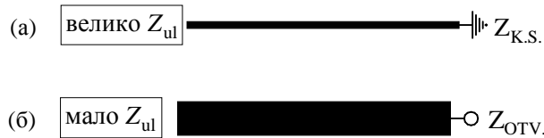
Слика 6.15. (а) Кратко спојени и (б) отворени четвртталасни огранак тракастог или микротракастог вода.
