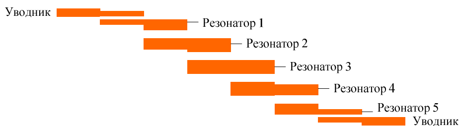
Слика 8.37. Скица врућих проводника филтра са паралелно спрегнутим полуталасним резонаторима реализованог у техници тракастих или микротракастих водова.
