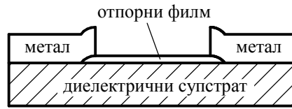
Слика 5.12. Скица отпорника у технологији танких и дебelih филмова.
