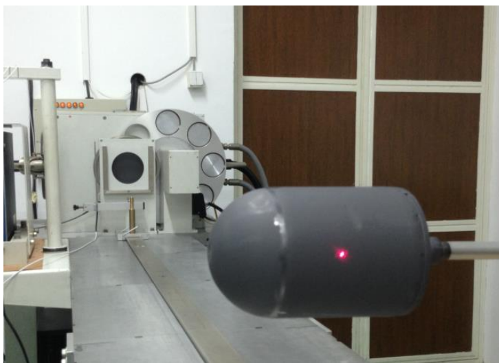
Slika 5.20. Testiranje jonizacione komore M1000 korišćenjem izvora X zračenja
