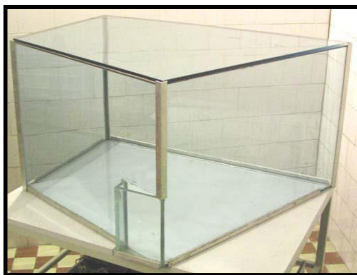
Slika 4.1. Model reverberacione komore u razmeri 1:10 za merenje koeficijenta apsorpcije materijala koji se koriste za izradu modela [94]
