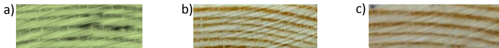
Slika 7.15. Poprečni preseki uzoraka na kojima su vršena ispitivanja uticaja dugotrajnih vibracija na mehaničke karakteristike drveta: a) S2; b) S6; c) S7
