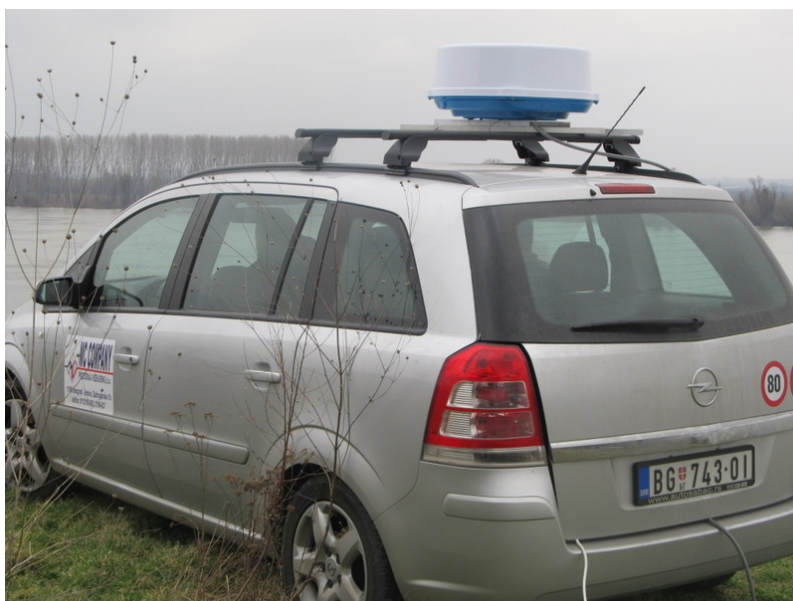
Slika 5.17: Izgled primopredajnika radara ONWA montiranog na putničkom vozilu za vreme funkcionalnog testiranja
