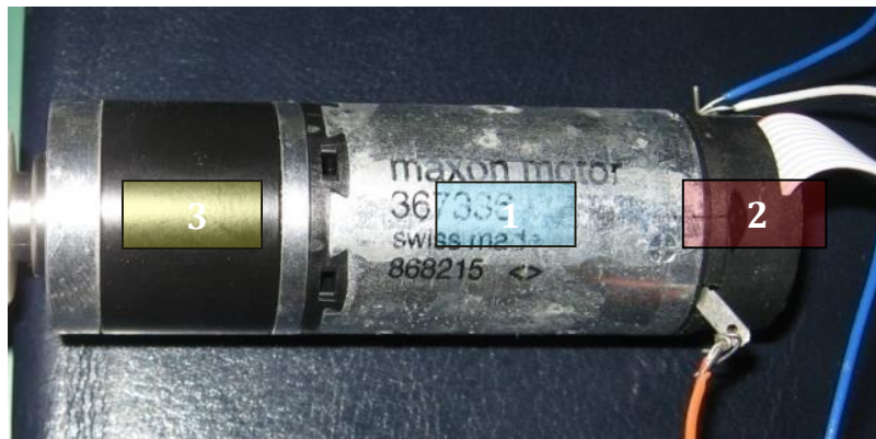
Сл. 3.1 (1) Микро-мотор једносмерне струје (2) енкодер (3) редуктор
