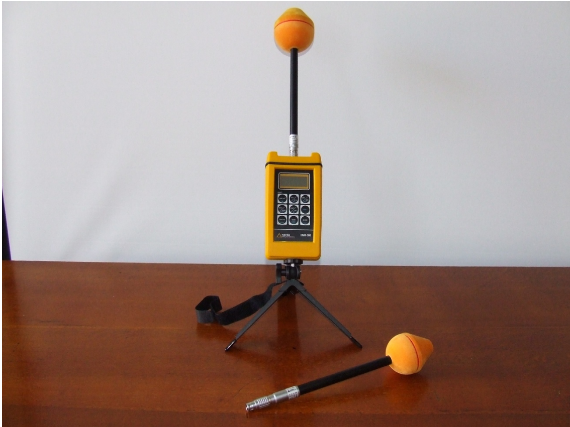
Slika 2.1 Prikaz širokopolasnog mernog sistema koji se sastoji od mernog prijemnika NARDA EMR300 i izotropnih mernih sondi NARDA TYPE 18c i NARDA TYPE 9c
